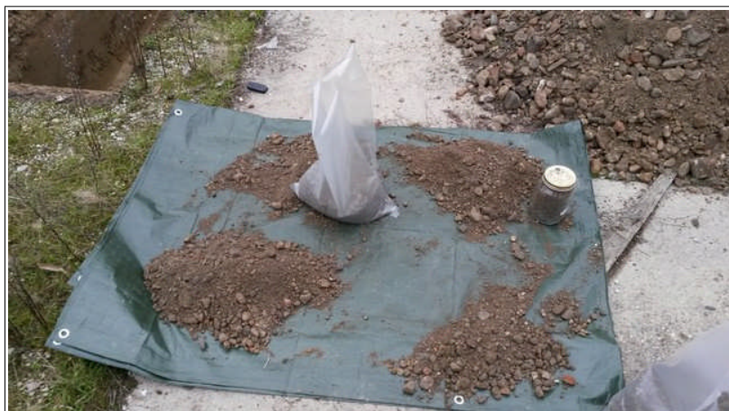
Foto 5.5 – procedimento della quartatura (trincea TR3)
